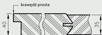
Przekrój poziomy drzwi Elsa
