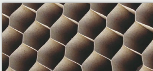
Rys.A. Wkład stabilizujący „plaster miodu”
