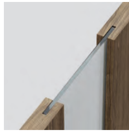
łączenie z szybą „na kant” skrzydło bezprzylgowe
